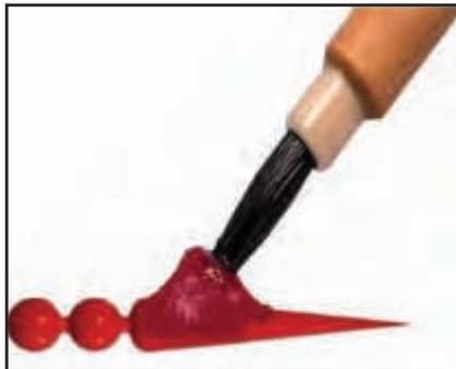
Рис. 6. Нанесение материала на заготовку полимерного беззольного штифта
